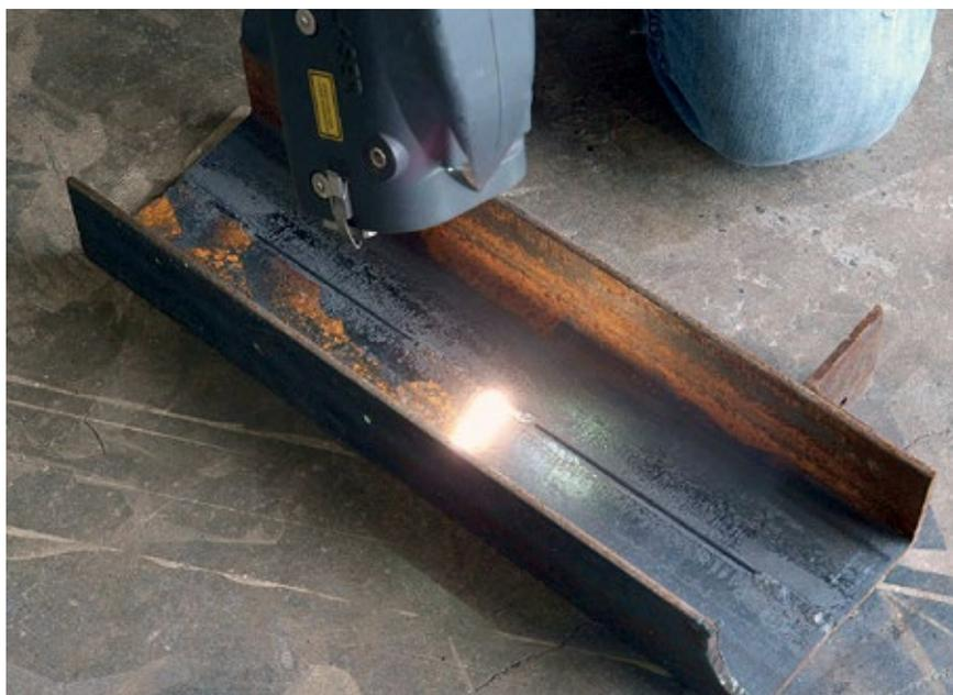
trice, un tubo flessibile, un manipolo. Il generatore è il vero cuore del sistema: infatti racchiude tutte le componenti elettroniche, compreso naturalmente il generatore del flusso laser. Da qui si diparte un cavo in fibra ottica (le lunghezze in commercio possono variare da 3 a 10 metri, a seconda delle necessità, ma si può arrivare anche a molto di più, fino a 50), mentre il manipolo è lo strumento che contiene le lenti.
