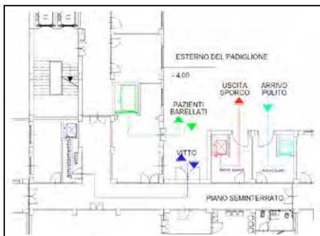
Figura 5 – Percorsi pazienti barellati e materiali al piano seminterrato
