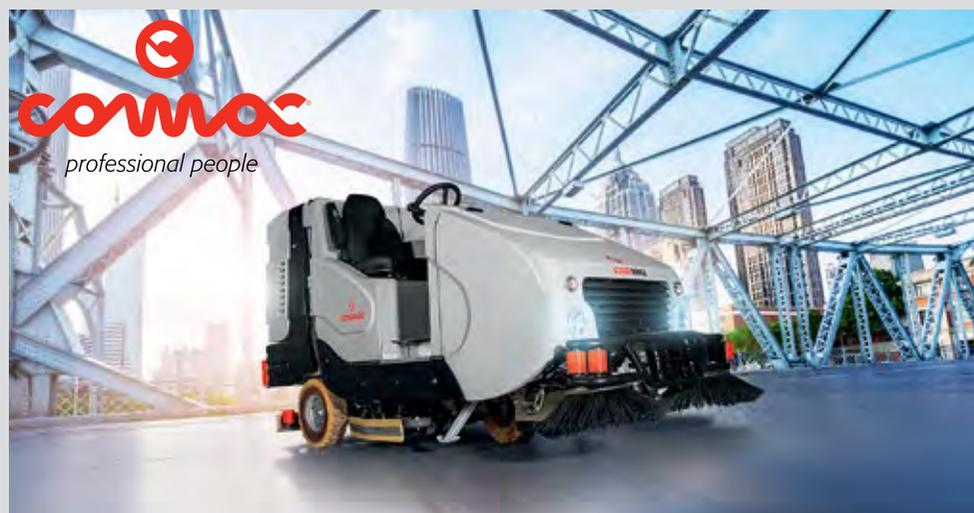
il pavimento perfettamente pulito. Le spazzole, la trazione e l'aspirazione sono controllate da un sistema idraulico che assicura la massima affidabilità. La postazione di guida è molto confortevole, anche in caso di turni lunghi e sia il volante che il sedile possono essere regolati secondo le esigenze dell'operatore. È dotata di un display touch-scre-
