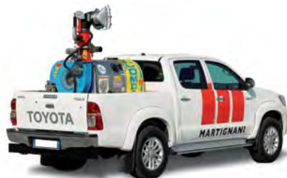
di testate cannone, accessori, pompe, ecc. La nuova invenzione di Martignani è la testata a cannone "Plug&Play", che permette di poter passare nel giro di pochi istanti da un trattamento a "lunga gittata" con la testata a cannone classica, al trattamento ad "ampio spettro" con la testata a ventaglio. Altra novità assoluta è la testata "Dual", che permette di trattare bidirezionalmente, ideale per trattamenti ULV adulcificanti.
