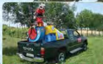
Nebulizzatori a cannone (13 a 140 CV) con ULV, Termonebbiogeno e carica Elettrostatica delle goccioline integrati
