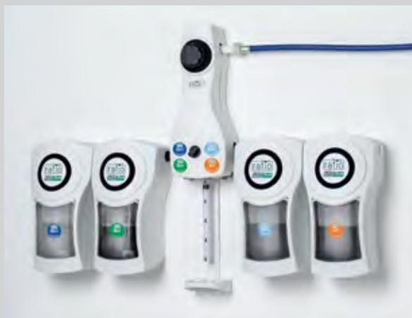
fetto Venturi diluendolo nella percentuale desiderata, per ottenere la giusta concentrazione di pronto all’uso con una semplice pressione sul pulsante di erogazione. Il rapporto di diluizione si imposta con un anello di dosaggio ed i sistemi sono disponibili in versione a bassa portata (4L/minuto per flaconi/trigger) e ad alta portata (14L/minuto per secchi).
