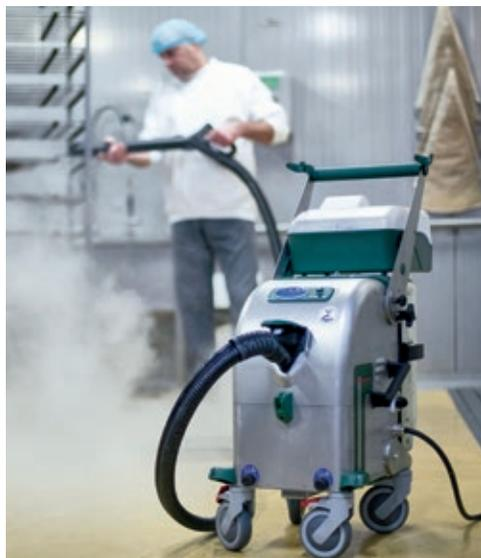
Nell'industria alimentare il vapore saturo ad alta temperatura è una soluzione efficace ed ecologica per il lavaggio di pavimentazioni, macchinari e nastri trasportatori.
