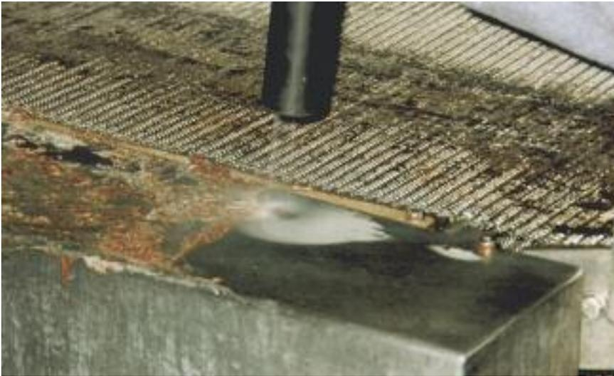
sistema non è nemmeno corrosivo, in quanto i pellets di anidride carbonica hanno una debole coesione. Tanto che anche materiali come alluminio e plastiche possono essere puliti senza il minimo danno.
