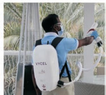
Vycel rilascia microparticelle di acqua cariche elettrostaticamente che si respingono ma vengono attratte da superfici cariche negativamente. Si produce così una nebbia uniforme che avvolge le superfici.
