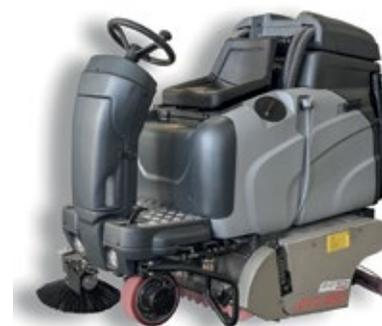
– Rullo Ø300 fa 920 rpm/min e che solleva l'acqua ed i detriti, che si fermano nel cassetto in rete; l'acqua sporca non torna sul pavimento entra in una vasca ed aspirata; il rullo raccoglie 80% di acqua, il tergi solo il 20%. Come una motoscopa senza filtri che usa acqua come filtro assoluto. La velocità del rullo, la pressione sul pavimento, l'azione della soluzione chimica permette di spazzare e lavare. [www.evotechitalia.com/](http://www.evotechitalia.com/)
