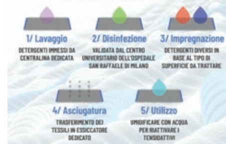
Il processo di impregnazione a secco per mop e panni ClaraClean
