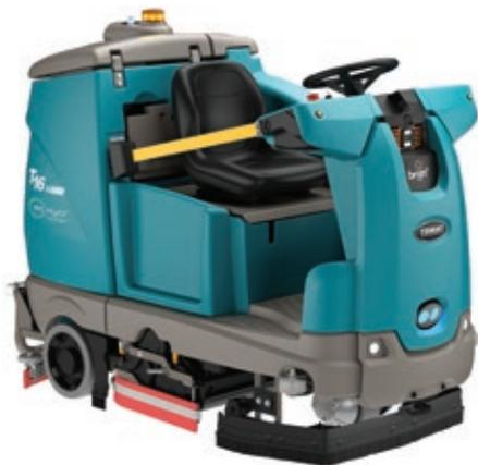
diretto dell'operatore. Il sistema di mappatura memorizza più percorsi e sequenze, l'AI elabora i segnali dei sensori e guida la pulizia autonoma in totale sicurezza, mentre il sistema di telemetria fornisce al supervisore notifiche in tempo reale e report settimanali. Non mancano le tecnologie esclusive Tennant, come eco-H2O NanoClean® per lavare senza l'uso di detersivi, le spazzole cilindriche per il pre-spazzamento, e il tergipavimento parabolico per una asciugatura sicura.
