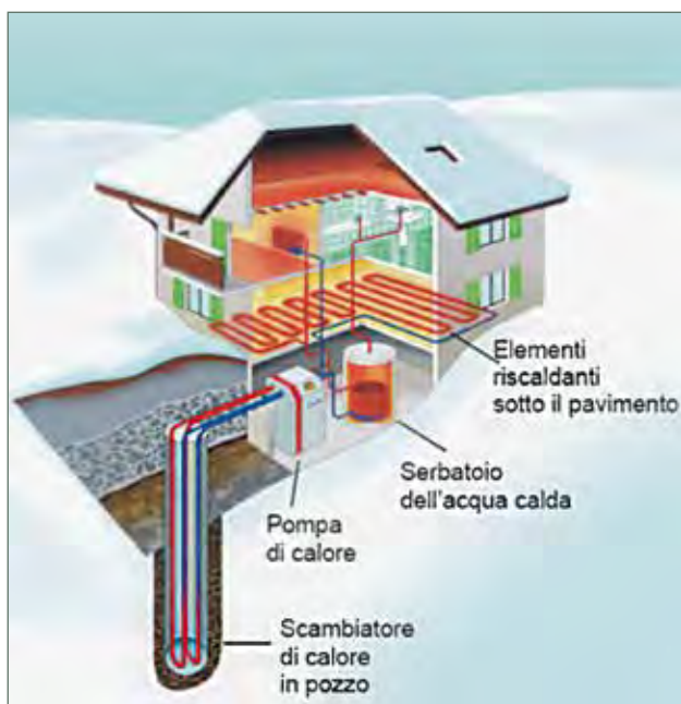
Figura 3 - Schema di impianto geotermico a bassa entalpia (a sonda verticale)
