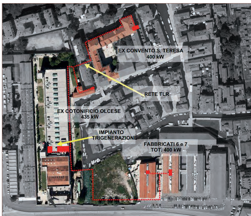
Figura 2 - La rete di teleriscaldamento in progetto con le relative utenze
