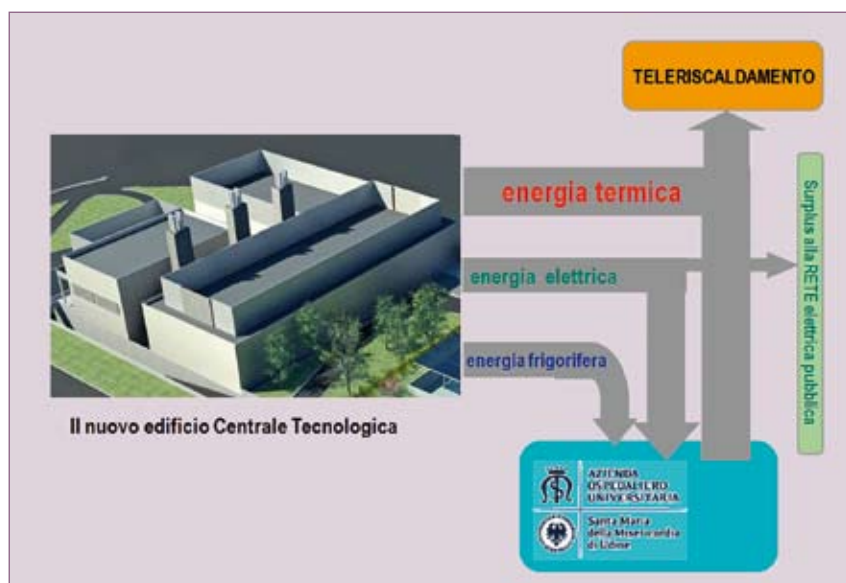
Figura 6 - Schema della produzione di energia della nuova centrale tecnologica
