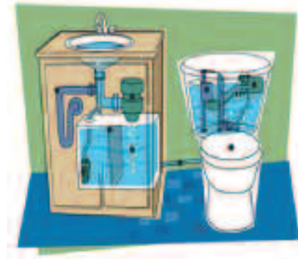
Sistema di recupero acque di scarico dei lavabi per alimentazione vaschetta WC (a fianco) e schema di recupero acque piovane (sotto)
