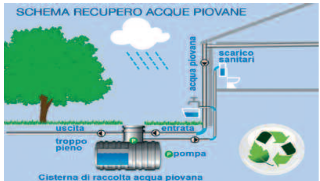
Sistema di recupero acque di scarico dei lavabi per alimentazione vaschetta WC (a fianco) e schema di recupero acque piovane (sotto)
