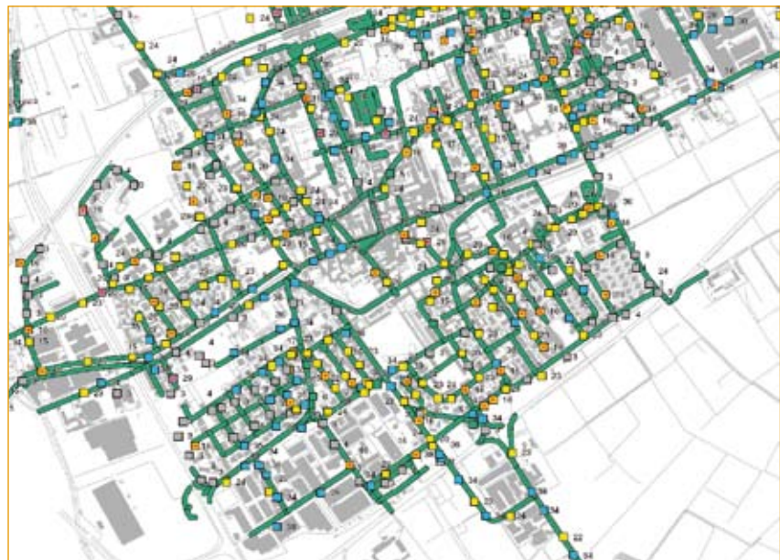
Figura 2 - Georeferenziazione del rilievo dei dissesti stradali
