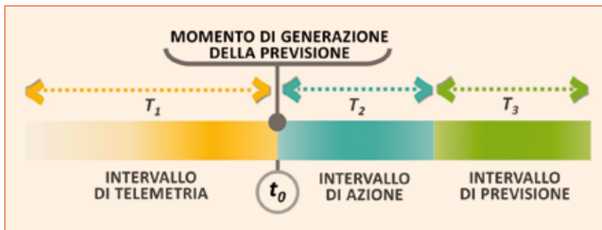
Figura 2 - Processo temporale del “Machine Learning”: l’algoritmo analizza i dati per un certo periodo di tempo ( T_1 - intervallo di telemetria) e restituisce al tempo T_0 la previsione di accadimento, ovvero uno score, un numero reale compreso nell’intervallo [0,1] che dà un’indicazione della probabilità che tale evento stia per verificarsi entro l’intervallo di previsione T_3 .
